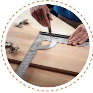
La escuadra de acero, de carpintero o de espaldón, consiste de una pieza metálica plana en forma de "L". Tiene un lado corto llamado espaldón que nos sirve para apoyar la escuadra en el canto de una pieza y poder verificar si nuestro ángulo está en  $90^\circ$  y uno largo y más delgado con medidas en centímetros y pulgadas que se encuentran formando un ángulo recto. Con esta herramienta también podemos medir ángulos en  $45^\circ$  por el vértice de su ángulo.
