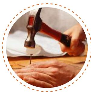
La mejor forma de colocar los clavos es con un leve ángulo, evitando que queden todos paralelos, esto ancla la pieza con mayor firmeza debido a que se bloquean respecto al ángulo de salida de la pieza de madera, además es bueno colocarlos en zig zag o diagonal, igual que en el caso de los tornillos) cuando lo permita la fijación para no generar una grieta a lo largo de la veta.
