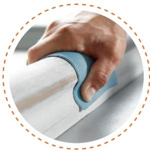
Si la lija se pasa directamente con la mano se pueden seguir contornos con formas orgánicas, la madera tiene diferentes durezas en su superficie que pueden ser resaltadas debido a zonas que se desbastan más fácil que otras, para contrarrestar esto se puede utilizar un taco de madera tras la lija y así lijar superficies planas con mayor control<sup>23</sup>.
