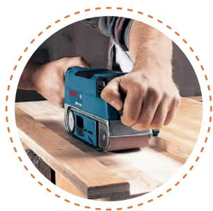
Las lijadoras de banda son las más agresivas, quitan material en una sola dirección y a gran velocidad, si no se utilizan con cuidado pueden dejar grandes hendiduras en la madera, utilizan lijas con forma de huincha como insumo, sirven para superficies amplias y de fácil acceso.
