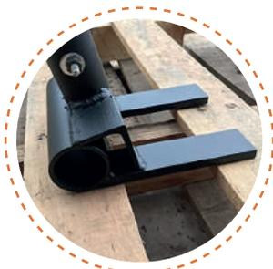
El “desarmapallets” es una herramienta artesanal que surgió desde la necesidad de reutilizar la madera de los pallets de transporte, consisten en una larga barra cuya función es de palanca que en uno de sus extremos tiene dos pletinas separadas (dientes) y paralelas en ángulo con respecto a la barra, extrae las tablas en conjunto con los
